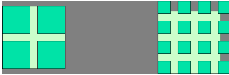
Figure 3. Illustration de la variation de la luminance avec l'augmentation de la résolution. La surface couverte par le matériel utilisé pour maintenir les cristaux liquides rempli de plus en plus la surface du panneau lorsqu'on augmente la résolution.
