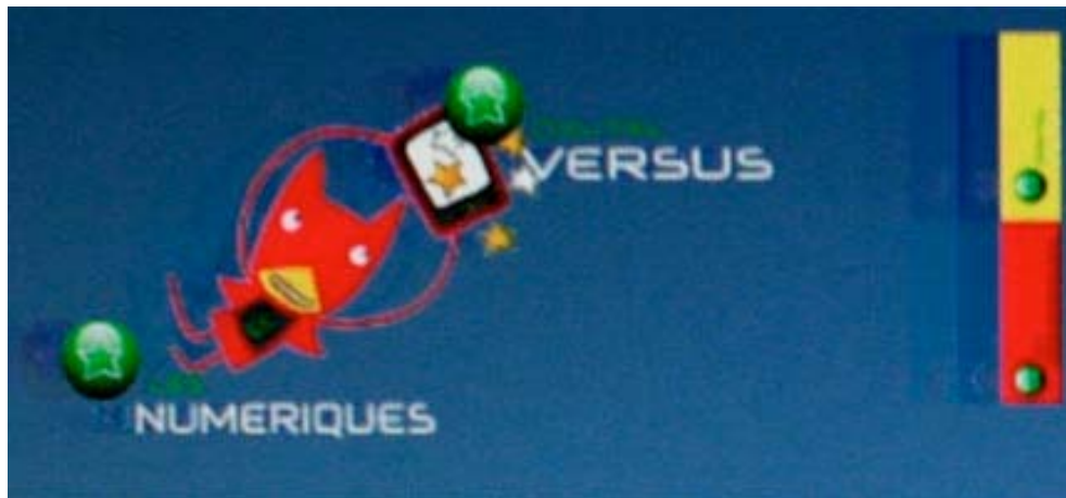
Figure 28 : La correction du défaut de rémanence sur cet écran la rémanence elle-même. Une image fantôme négative suit l'image en mouvement. C'est le reverse ghosting. (source: lesnumeriques.com )
