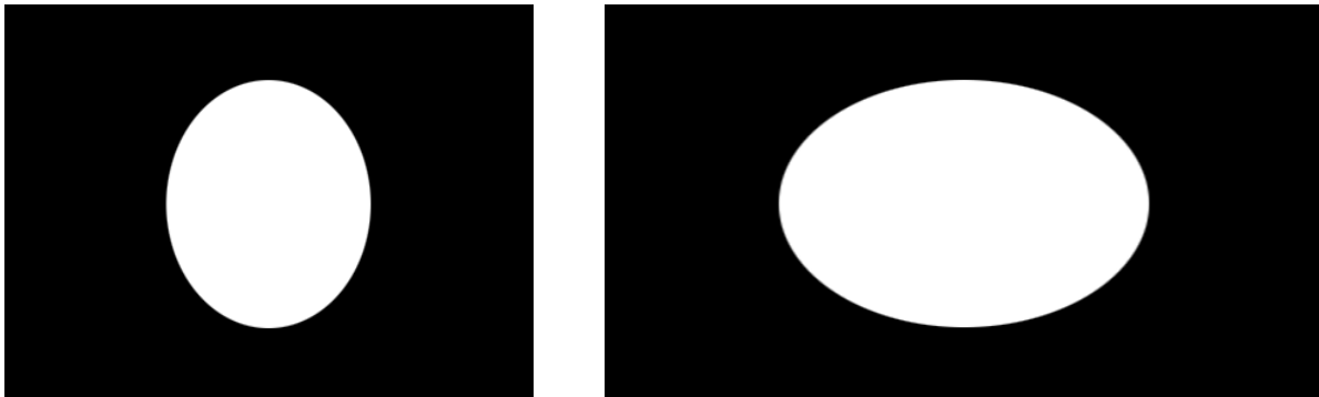
Figure 26: Rond blanc sur fond noir. A droite, anamorphose dû au passage du 4/3 au 16/9, et à gauche, du 16/9 au 4/3
