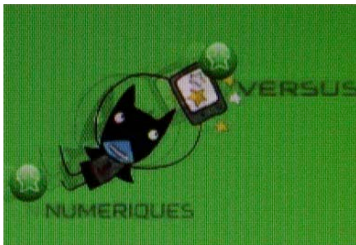
Figure 27: Un écran LCD montrant un fort défaut de rémanence (source: lesnumeriques.com)
