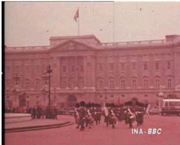
Figure 7: le vieillissement des colorants dans ce film a désaturé les couleurs et fait viré les couleurs vers le magenta
