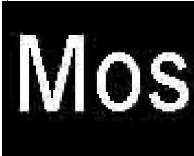
Figure 23 : Exemple du bruit de moustique sur une image très compressée
